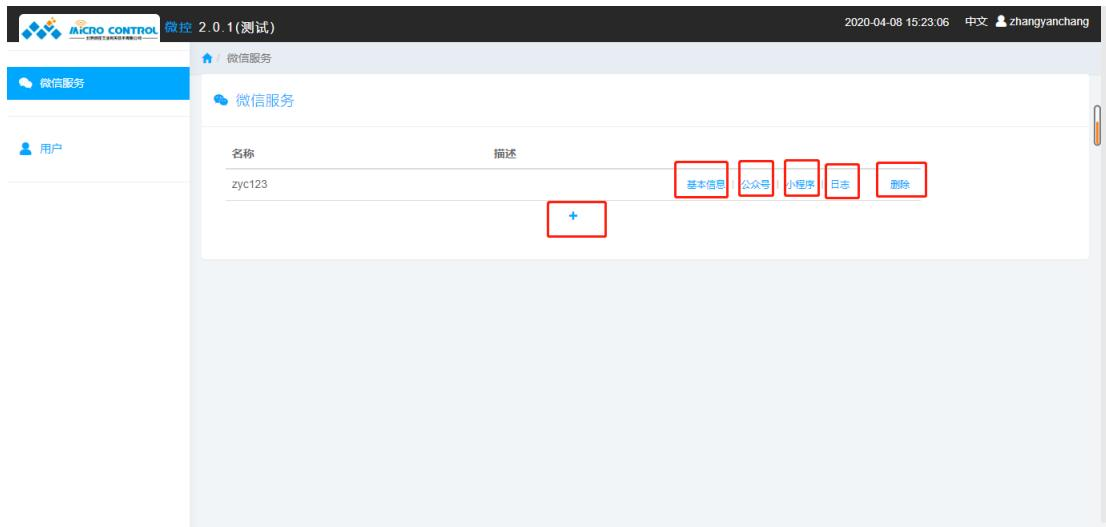
点击【+】，弹出创建微信服务模拟框，一共有三项其中名称和服务密钥是必填项，自行填写（名称最大长度为 16，服务密钥长度必须为 43 并且只能由大小写字母和数字组成，可以通过输入框后的随机生成自动生成一个密钥。如下图：
