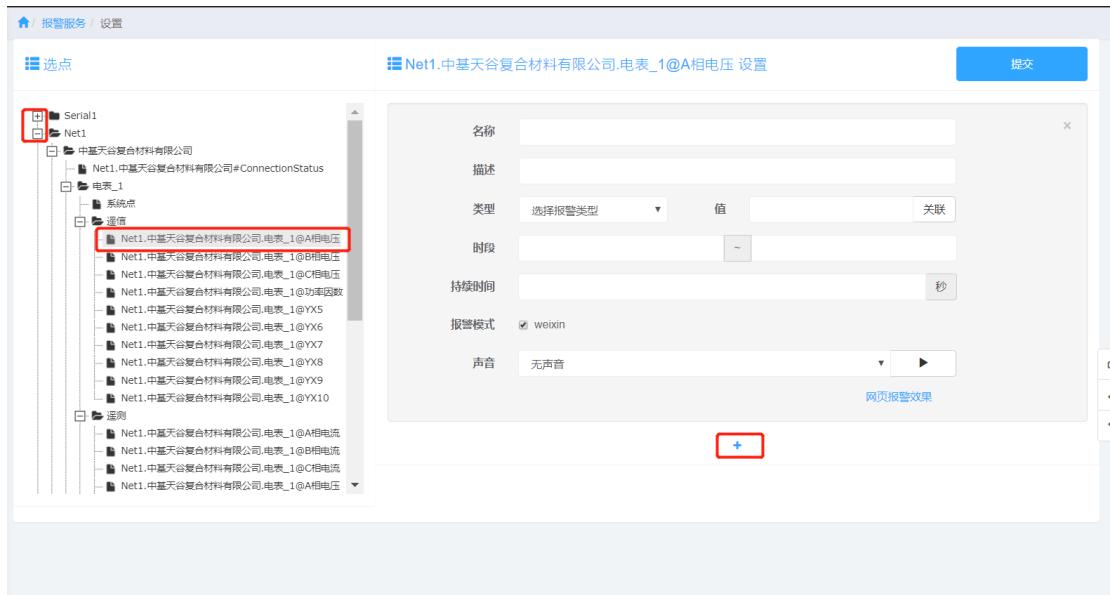
报警设置是对网关通道信息下已配好的点进行报警提示服务的设置，以树结构的形式进行展示，选择具体的点进行配置。如上图。
