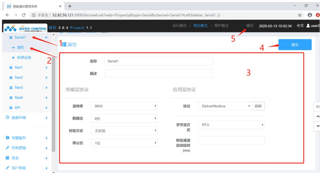
串口属性配置页面，选择左侧 Serial1(串口)，点击属性，右侧会出现串口属性配置
