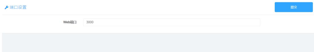
Web 端口号可以进行修改，保证唯一即可。如该端口号设置为 80，访问页面时 IP 地址后面不需要添加端口号；如设置为其他端口号，则需要在 IP 地址后面加上 “:端口号” ，如 192.168.1.10:3000
