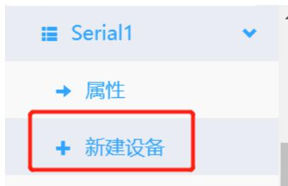
点击串口下的“新建设备”一栏, 出现如下图所示配置界面: (注: 该例子是以 modbus 协议举例, 现场请按照实际需求进行配置)
